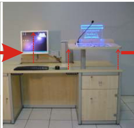
2) Höhe des Monitors einstellen sowie Neigung verstellen, Tastatur und Maus entnehmen
