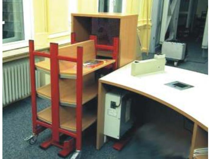
Elektromotorisch höhenverstellbare Thekenanlage in der Stadtbücherei Iserlohn mit Monitorverblendungen aus Lochblech und eingearbeitetem "Plexicor" in die Thekenoberfläche, Bücherwagen elektromotorisch auf Thekenniveau anhebbar, Technik in die Thekenanlage eingebaut, hebt sich mit der gesamten Thekenanlage an.
