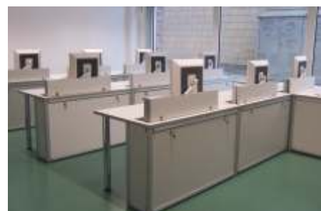
Schulungsräume in der Bibliothek der TU - Berlin "Volkswagenuniversitätsbibliothek" mit versenkbaren, drehbaren und kippbaren Monitoren komplett elektrifiziert, mit verschließbarer und abnehmbarer Rückwand, Dozententisch zusätzlich mit elektromotorisch höhenverstellbarem Rednerpult
