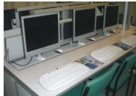
Schulungsraum der Beschaffungsstelle der FU Berlin mit versenkbaren Monitoren für 3 Nutzer mit Thin Clients von HP, an der Hubeinrichtung mit befestigt
