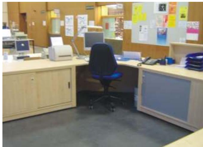
Die Thekenanlage der Beratungstheke der Universitätsbibliothek München wurde auf einem Podest montiert. Damit ist der Blickkontakt zwischen Nutzer und Mitarbeiter gewährleistet. Die TFT-Monitore sind an Monitorsäulen über den VESA-Standard mittels Dreh-Kipp-Gelenk befestigt. An der Stirnseite der Anlage befindet sich ein Thekenaufsatz mit Aluminium-Nuten-System zur Einhängung von Prospekthaltern.
