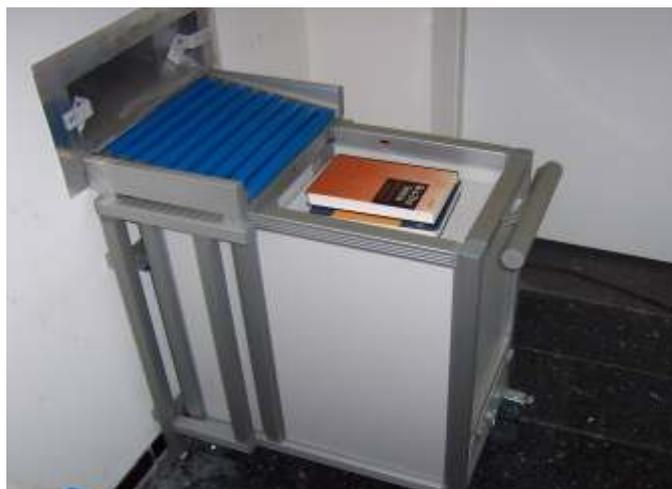
Der elektromotorische, automatisch höhenverstellbare Nachrückgabe-Wagen ist hier in der Ausführung mit einer Kammer zum Einsatz gekommen. Eine Rollenbahn befördert das Buch in den Wagen, dieser legt das Buch sanft mittels Elektromotorik im Wageninneren ab. Eine intelligente Sensorik erkennt im Zusammenspiel mit der Wagentechnik, ob die Bücher gerade aus- oder eingeladen werden und fährt somit die Bücher ein oder aus. Der Bücherwagen ist mittels Akku-Betrieb überall elektromotorisch auszuladen.
