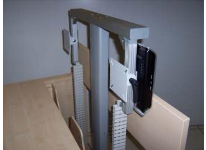
Hier stellen wir Ihnen den fahrbaren Dozententisch mit elektromotorisch versenkbaren Monitoren und einem Beamer-Tragarm mit Säule vor. Durch die Traverse aus unserem Aluminium-Baukastensystem und die daran befestigten Ausleger lassen sich mit einer Hubsäule 2 Monitore heben, und zusätzlich können an diesen Auslegern Arbeitsstationen für ThinClients oder Office Stationen befestigt werden, die beim Einfahren der Monitore mit im Tischinneren versenkt werden.
