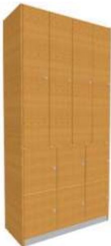
Bild links: Taschenschrank B1000xT520xH2000 mm unten 6 abschließbare Taschenschließfächer, 3 Fächer neben- und 2 Fächer übereinander, oben 4 Garderobenabteile nebeneinander, Korpusbauweise mit Sockel, Material: E1- Gütespanplatte mit Melaminharz Beschichtung Art.-Nr.: SOTS6F4GATH
