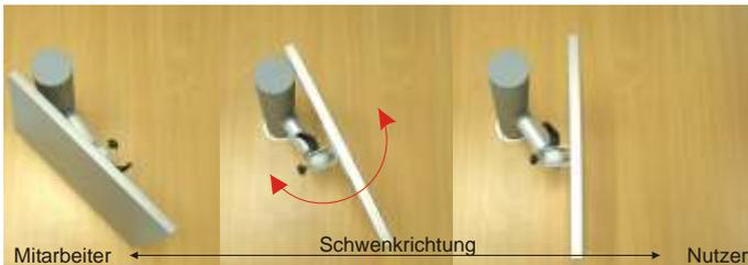
Funktionsprinzip Typ B und Typ C mit Schwenken des TFTs zum Nutzer
