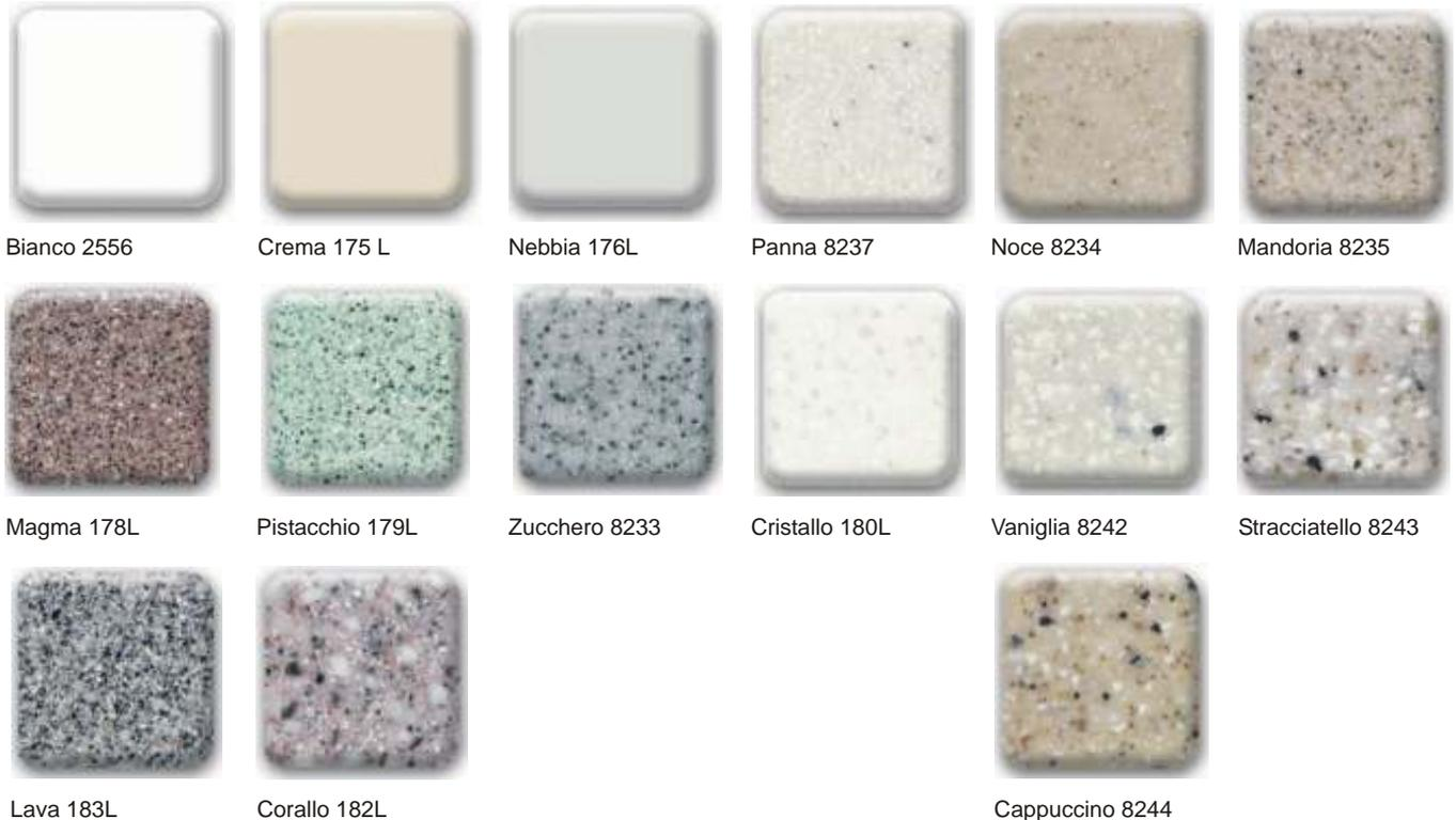
RAUSOLID ist ein massiver, voll durchgefärbter Mineralwerkstoff, der zu einem Drittel aus Acrylharz und zu zwei Dritteln aus Aluminiumhydroxid mit Farbpigmenten besteht. Die positiven Eigenschaften der einzelnen Komponenten verbinden sich zu einem vielseitig verwendbaren Material mit steinähnlicher Optik, wärmer, angenehmer Haptik und hervorragenden Verarbeitungseigenschaften.
