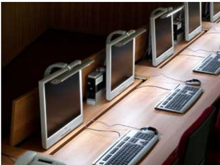
Die ThinClients fahren aus dem Tischinneren heraus u. können damit immer direkt bedient werden. Wenn keine Technik benötigt wird, fährt man diese komplett ein.
