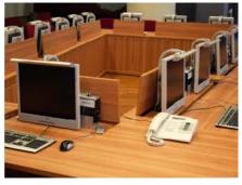
Auf Knopfdruck fährt die EDV-Technik, bestehend aus Micro-PC, TFT-Monitor, Maus, Tastatur und Arbeitsplatzbeleuchtung mit Kaltkathoden, aus dem Tischinneren heraus. Die Elektromotorik der Höhenverstellung und Versenkung ist in einem separatem Stromkreis abschaltbar. Somit hat der Dozent jederzeit die Kontrolle über diese Funktion.
